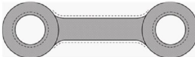
Рисунок Б.3.1 – Схема сканирования средней части буксового поводка и переходов к крепежным частям
