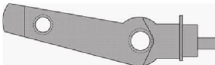
Рисунок Б.4.34 – Схема сканирования зон вокруг отверстий рычага 4075.42.140 клещевого механизма
