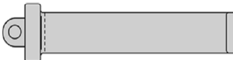
Рисунок Б.2.9 – Схема кругового сканирования поверхности шкворня
