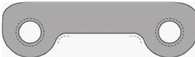
Рисунок Б.4.14 – Схема сканирования зон вокруг отверстий затяжки и углов сопряжения средней и крепежных частей затяжки клещевого механизма
