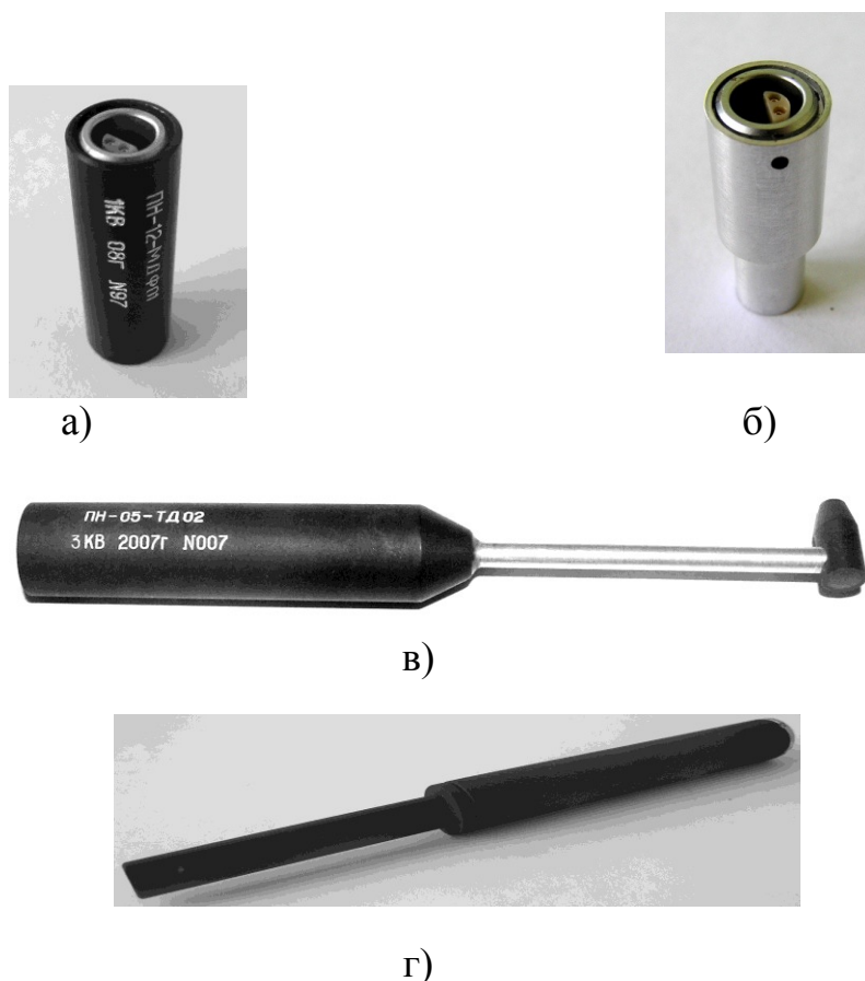
Рисунок В.6.2 – Общий вид ВП, входящих в состав дефектоскопа ВДЗ-71НК-IVУ типов: ПН-12-МДФ-Л-01 (а); ПН-09-МДФ-У-01 (б); ПН-05-ТД-02 (в) и ПН-6×8-ТД-01 (г)
