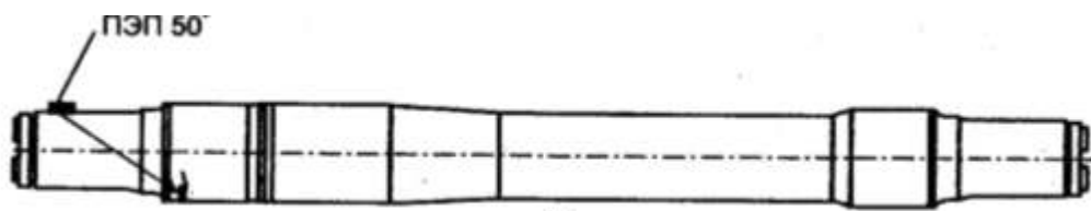
Рисунок 7.13 — Акустическая схема контроля внешних подступичных частей оси колесной пары с цилиндрической поверхностью шейки
