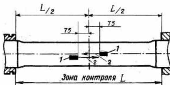
Рисунок 7.17 — Схема установки ПЭП при УЗК открытой поверхности средней части оси колесной пары поверхностными волнами
