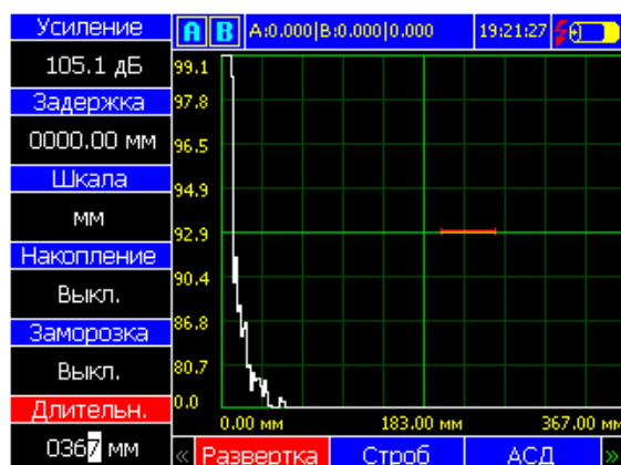
Рис. П.В.2.11 – Вид экрана дефектоскопа в подменю «Развертка», установка параметров
